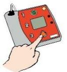
AED（自動体外式除細動器）とは、心臓がけいれんし血液を流すポンプ機能を失った状態（心室細動）になった心臓に対して、電気ショックを与え、正常なリズムに戻すための機械です。
